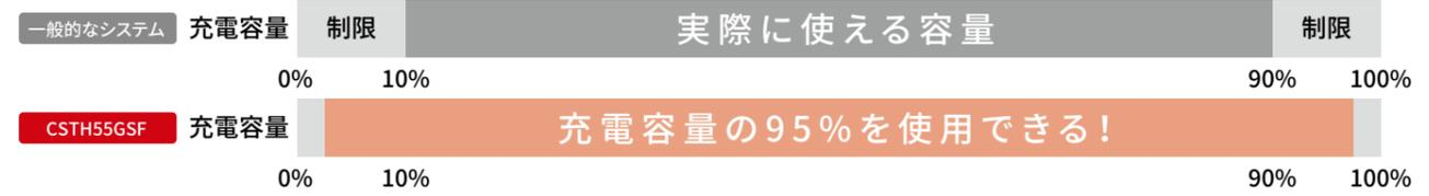
高性能・高耐久のリン酸鉄リチウムの採用で、“実効容量”は業界トップクラス。最大14.08kWh※の大容量を長く有効に使うことができます。
