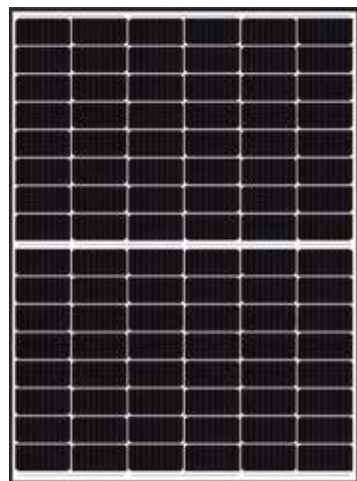
HiKu HIGH POWER MONO PERC MODULE CS3LA-300MS [単結晶 PERC] モジュール変換効率 20.1 % 公称最大出力 300 W 外形寸法: 1424×1048×35 mm 質量: 17.0 kg
