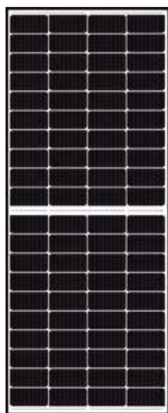
HiKu HIGH POWER MONO PERC MODULE CS3LB-250MS [単結晶 PERC] モジュール変換効率 20.0 % 公称最大出力 250 W 外形寸法: 1765×709×35 mm 質量: 14.5 kg
