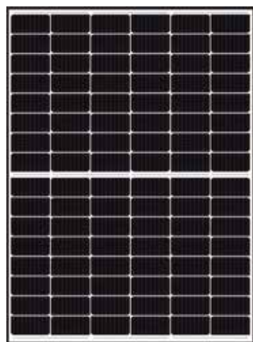
HiKu HIGH POWER MONO PERC MODULE CS3LA-300MS [単結晶 PERC] モジュール変換効率 20.1 % 公称最大出力 300 W 外形寸法: 1424×1048×35 mm 質量: 16.7 kg
